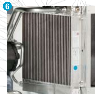
Połączona chłodnica powietrza i oleju
