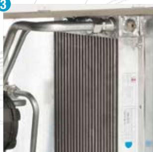
Połączona chłodnica powietrza i oleju
